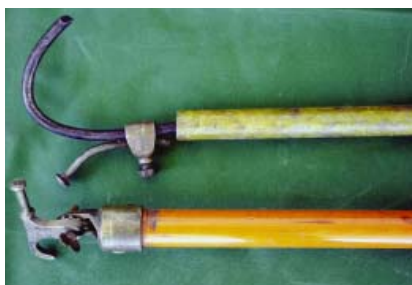
Ferramentas com isolamento elétrico: serra hidráulica e bastão de manobra. No detalhe, a ponta do bastão de manobra.
